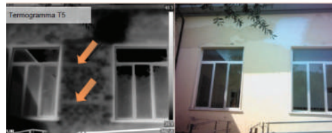
Figure 23: Termogramma T5 – in evidenza la presenza di ricorsi su murature in pietrame
