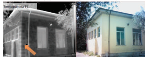
Figure 23: Termogramma T5 – in evidenza la presenza di ricorsi su murature in pietrame
